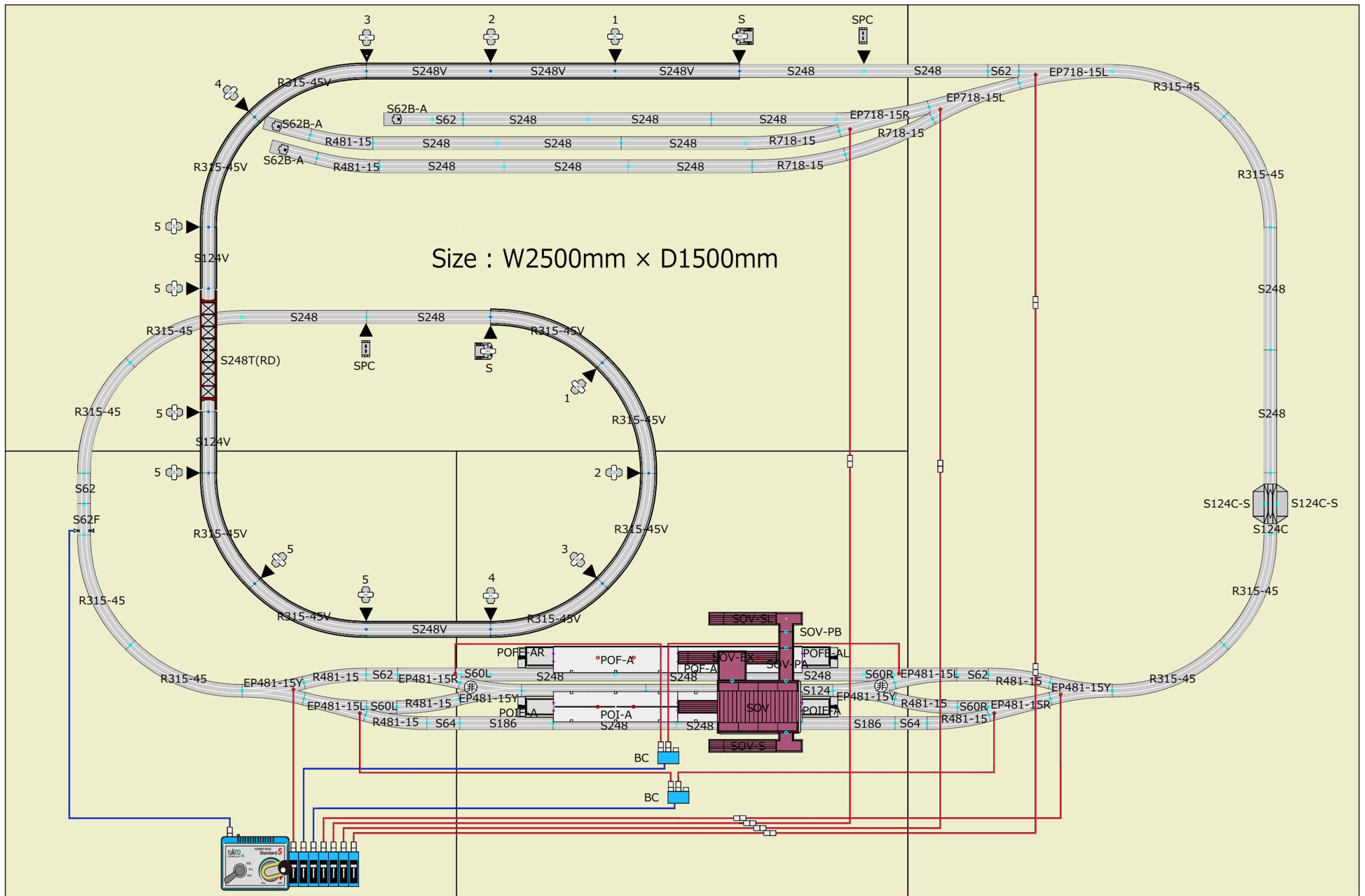
【非】マークの付いたY字ポイントは裏面の設定切替で「非選択」に設定し、進行方向左開きのスプリングポイントにします。
