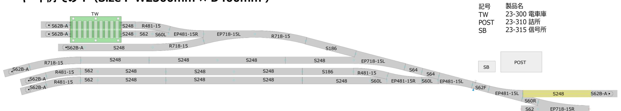
ヤードと併行に奥側に機関庫を配置し、機関車は右手の折り返し線を使ってヤードへの出入を行うプランです。
