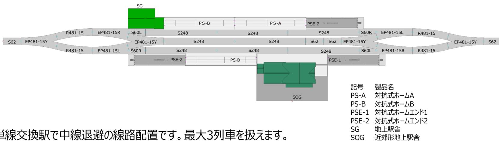
単線交換駅で中線退避の線路配置です。最大3列車を扱えます。
