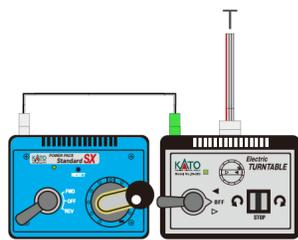
ターンテーブルは回転する桁の停止した両端に走行電流を供給しますので、桁が180度回転すると走行電流の極性が本線と逆になりショートしてしまいます。そのためターンテーブルを含む機関庫部分は**【絶縁ジョイナー】**を用いて本線と電氣的に分離して走行をコントロールします。
