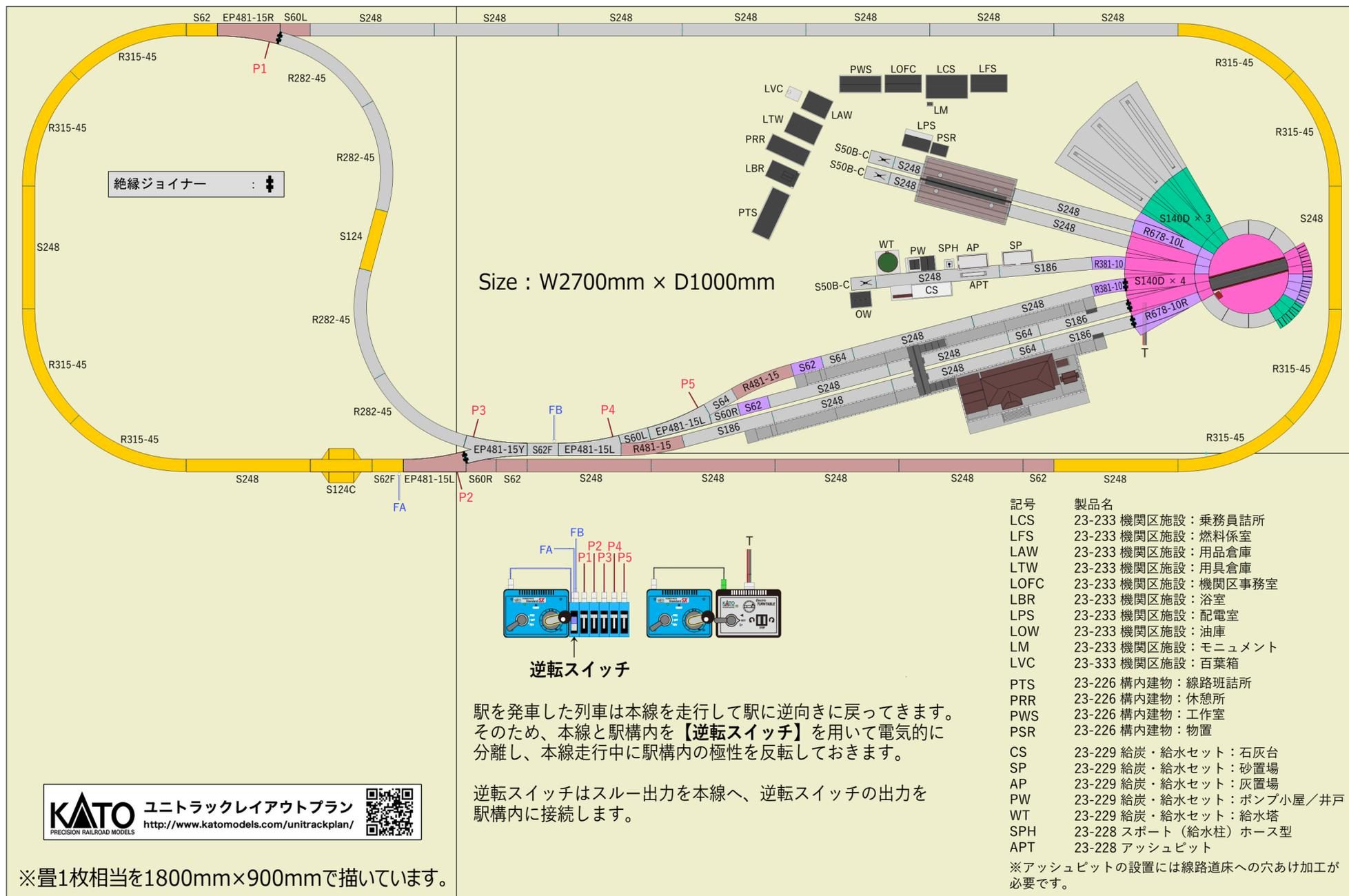
ターンテーブルは回転する桁の停止した両端に走行電流を供給しますので、桁が180度回転すると走行電流の極性が逆になります。ターンテーブルを含む機関区部分は【絶縁ジョイナー】を用いて、接続される駅構内と電氣的に分離して走行をコントロールします。
